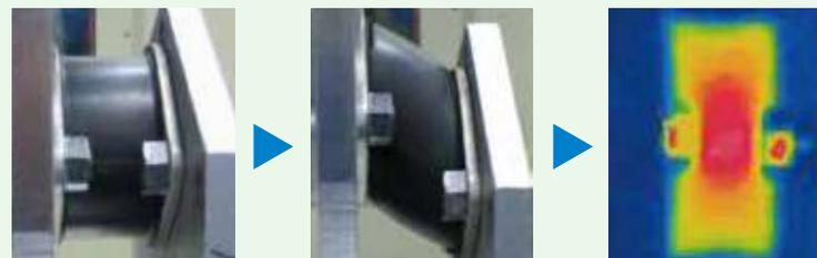
揺れの運動エネルギーを熱エネルギーに換えて、吸収・発散。鉄板と高減衰ゴムの間も「加硫接着」で強固に接着。揺れからしっかり守ります。
