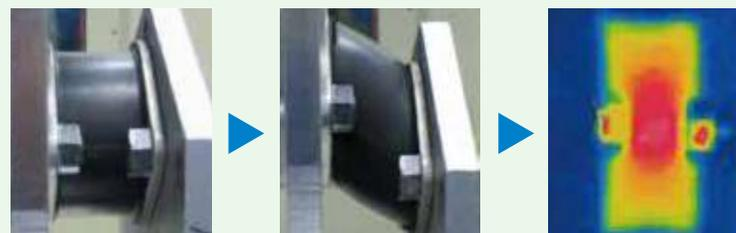
揺れの運動エネルギーを熱エネルギーに換えて、
